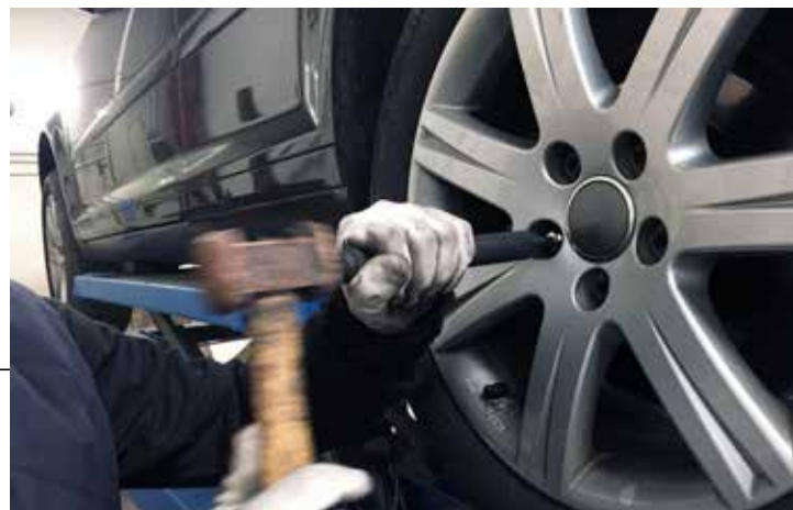
Une solution pour enlever les écrous de roue endommagés.
