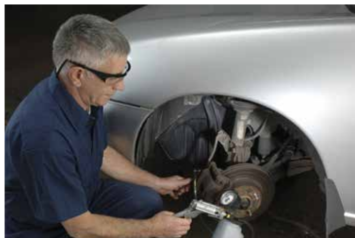
Tout a commencé avec la pompe manuelle Mityvac (pression/dépression), notamment utilisée pour purger le système de freinage.
